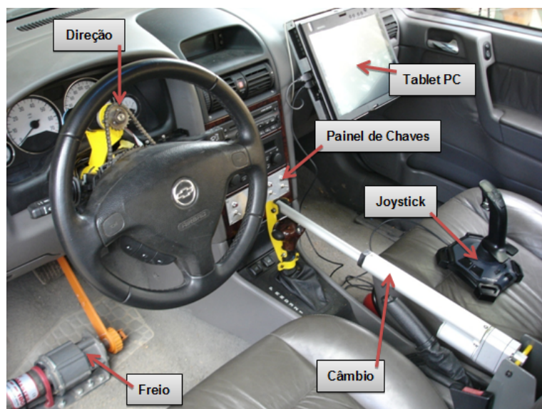
Figura 1.1: Automatização de um automóvel Chevrolet Astra pelo PDVA - adaptada de [30].
